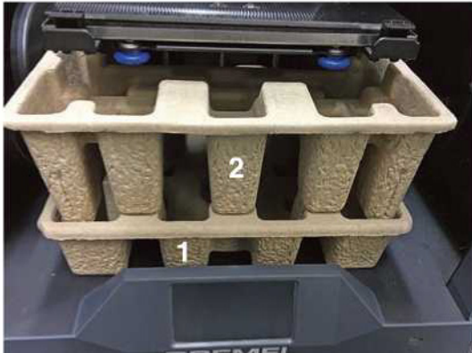
Étape 5 - Poussez le support de la plaque de construction vers le bas dans l'insert en carton 2.
