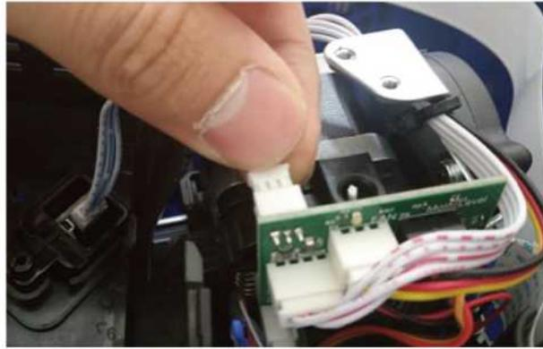
f. Rebranchez le connecteur de l'interrupteur de fin de course de filament de l'étape précédente. Fixez les deux vis sur le dessus du capot supérieur de l'extrudeuse à l'aide de la clé hexagonale de 2,5 mm. Fixez la vis droite sur le fond de l'extrudeuse enlevée à l'étape b à l'aide du tournevis Torx T10. Insérez le filament dans l'extrudeuse, et reprenez l'utilisation normale de l'imprimante.
