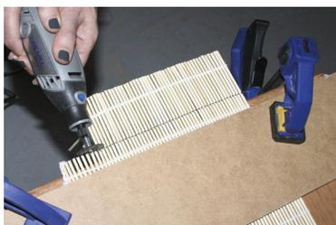
Ensuite, pour découper la natte en bambou, placez-la sur une table et en-dessus une planche. Fixez l'ensemble à la table avec un étau. En utilisant le Dremel 3000 et un disque de découpe, suivez la ligne de découpe sur la bambou pour obtenir la taille désirée.
