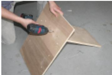
Tout d'abord, vous fixerez la base aux 3 côtés du 1er étage en utilisant des vis de 63mm.
