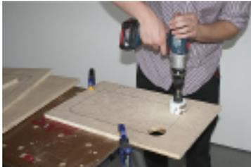
Pour créer les bords intérieurs incurvés, nous avons d'abord utilisé une perceuse sans fil équipée d'une scie cloche de 63mm et réalisé les découpes dans chacun des 4 coins.
