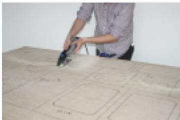
Ensuite, vous couperez chacune des pièces dans le contreplaqué. Nous avons utilisé la scie compacte Dremel équipée du disque SM500 pour réaliser des coupes droites le long des marques. C'est facile de faire des coupes plongeantes avec la scie compacte :
