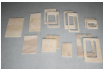
Disposez les pièces terminées pour les assembler et alignez les pièces adjacentes pour marquer les endroits précis où vous aurez besoin de faire des pré-trous à l'étape suivante.
